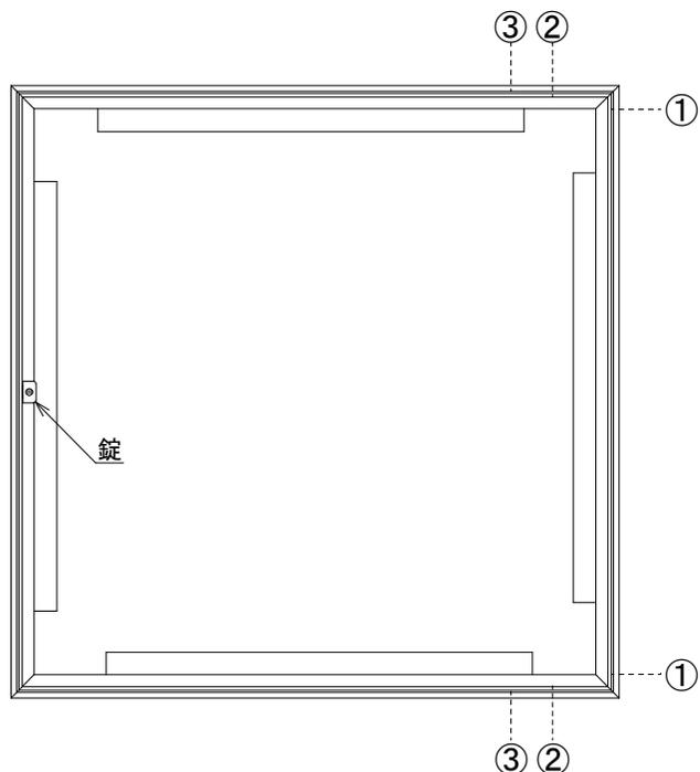
①外枠用平板（小）を外枠内側の図の位置に貼り付けてください。
