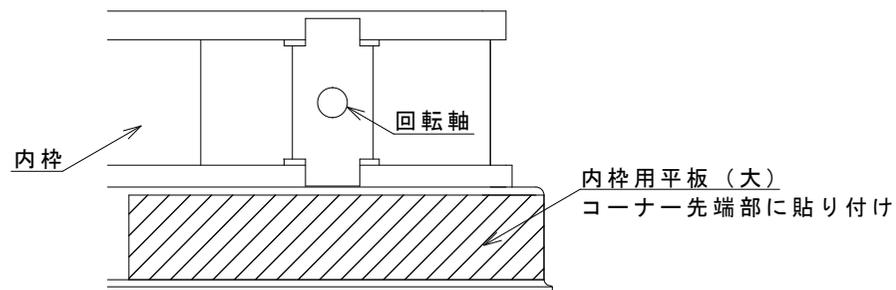
③内枠を取付け後開いた状態にて、外れ防止板を外枠内側の図の位置に合わせ長穴部の図の位置に3φの下穴をあけて、タッピングねじで固定してください。
